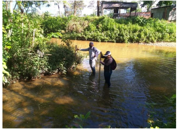
Ilustración 36. Registro de la altura de bancas y láminas de agua en la confluencia de aguas de los caños Aguas Claras y La Cuerera Fuente: El estudio
