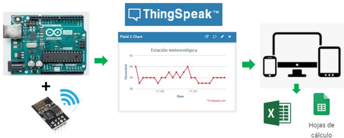
Figura 11 Esquema de funcionamiento de ThingSpeak
