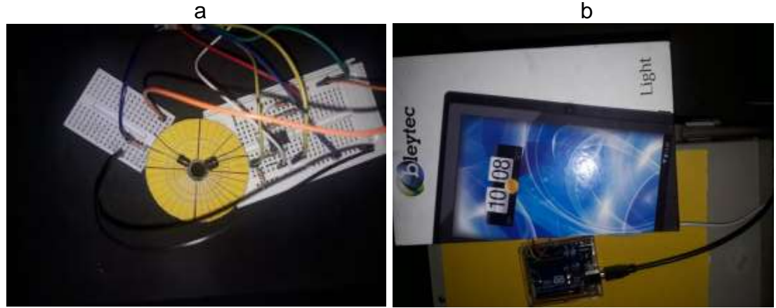
Figura 45. Escenario de la prueba de led IR con ángulo 30^\circ , ganancia de 10 y variando la resistencia del fotodiodo. a. Caja abierta. b. Caja cerrada.
