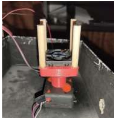
Figura 69. Escenario de la prueba del micronefelómetro con piezas 3D.
