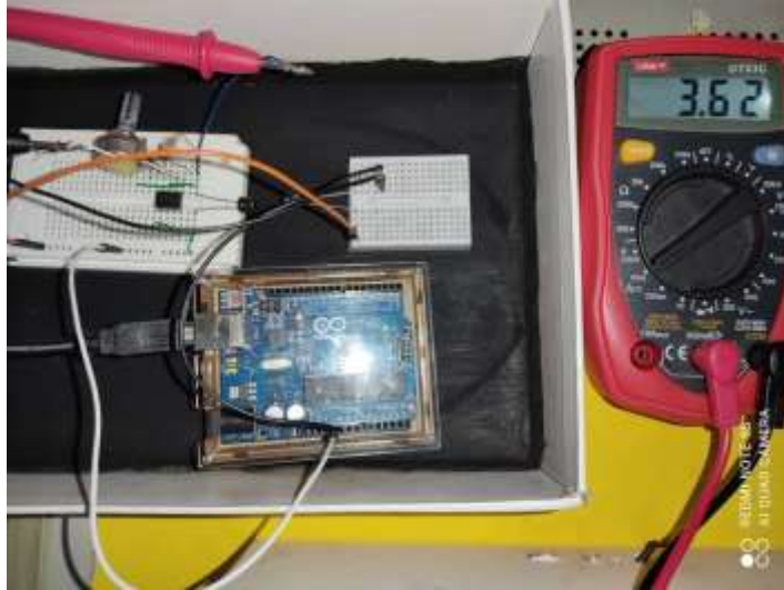
Figura 39. Medición de I_s en el fotodiodo.
