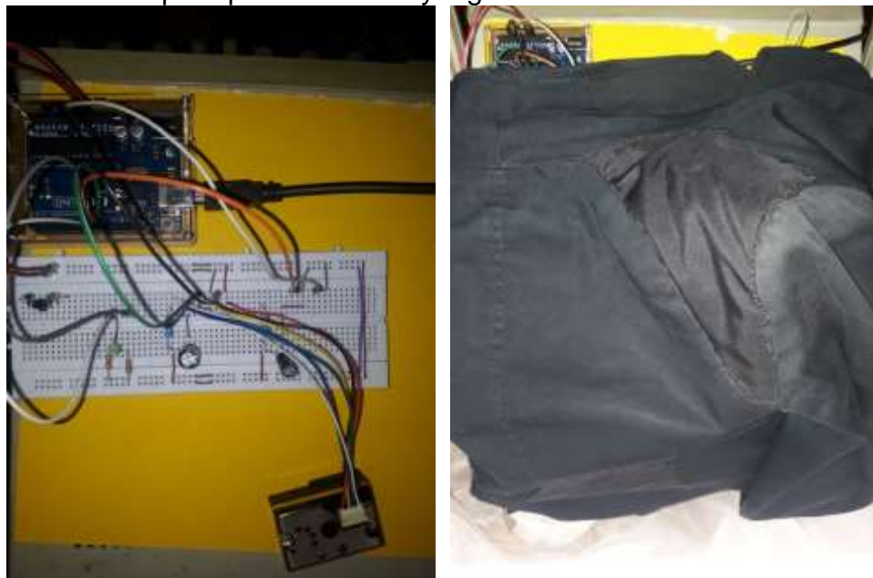
Figura 23. Escenario para prueba de Stray Light del sensor GP2Y.
