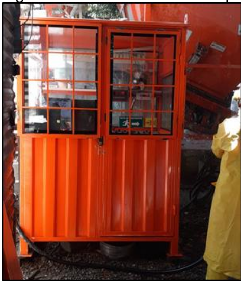
Figura 4. Cabina de control de plantas para producción de concreto
