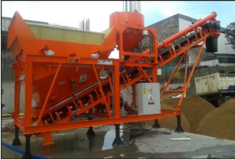
Figura 2. Planta dosificadora de concreto modelo AD-35m 3 /h
