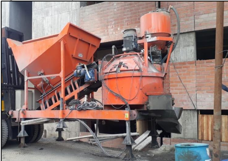
Figura 1. Planta premezcladora de concreto modelo AMP-15m 3 /h
