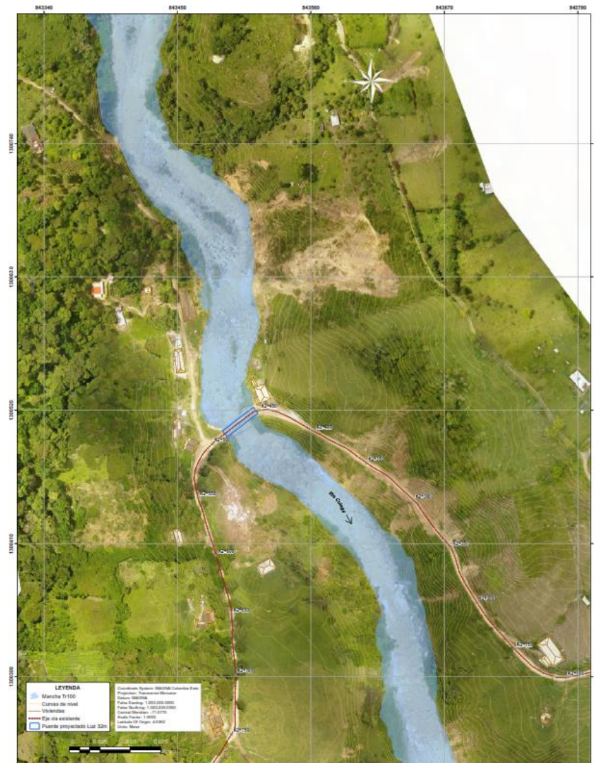
Figura 36. Mancha de inundación Q 100 años (Condición proyectada)
