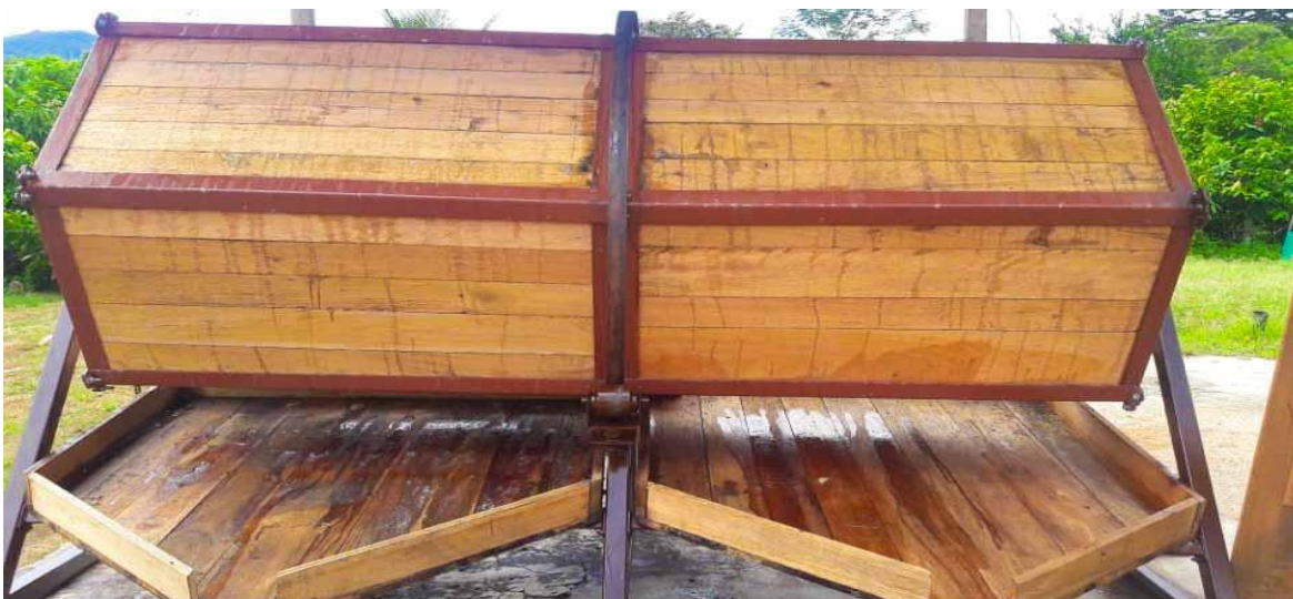
Figura 38. Cajón fermentador trapezoidal
