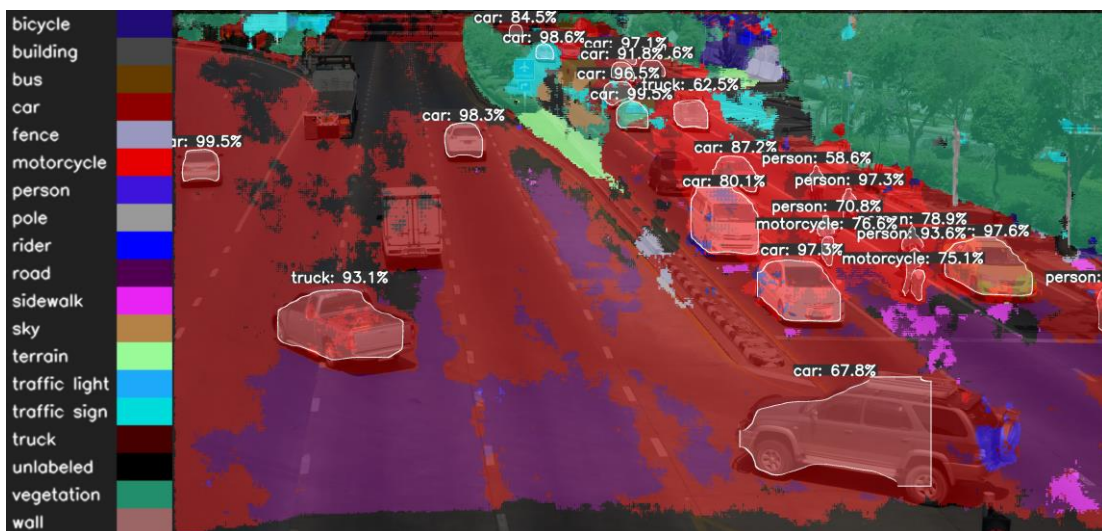
Figura 4.13 - Exemplo de detecção com o ENet + Mask R-CNN
