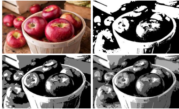
Figura 2.21 - Em cima: Original à esquerda, 1 threshold à direita; Baixo: 2 thresholds à esquerda, 3 thresholds à direita;
