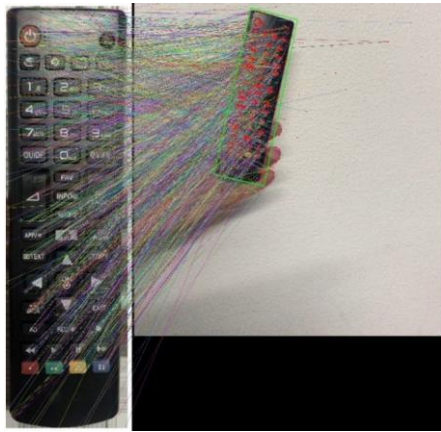
Figura 4.3 - Representação do processamento feito e dos resultados obtidos utilizando o SIFT
