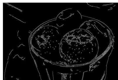
Figura 2.24 - Canny Edge Detector; 2ms
