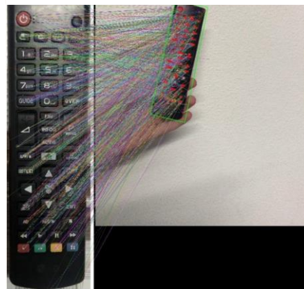
Figura 4.6 - Representação do processamento feito e dos resultados obtidos utilizando o BRISK
