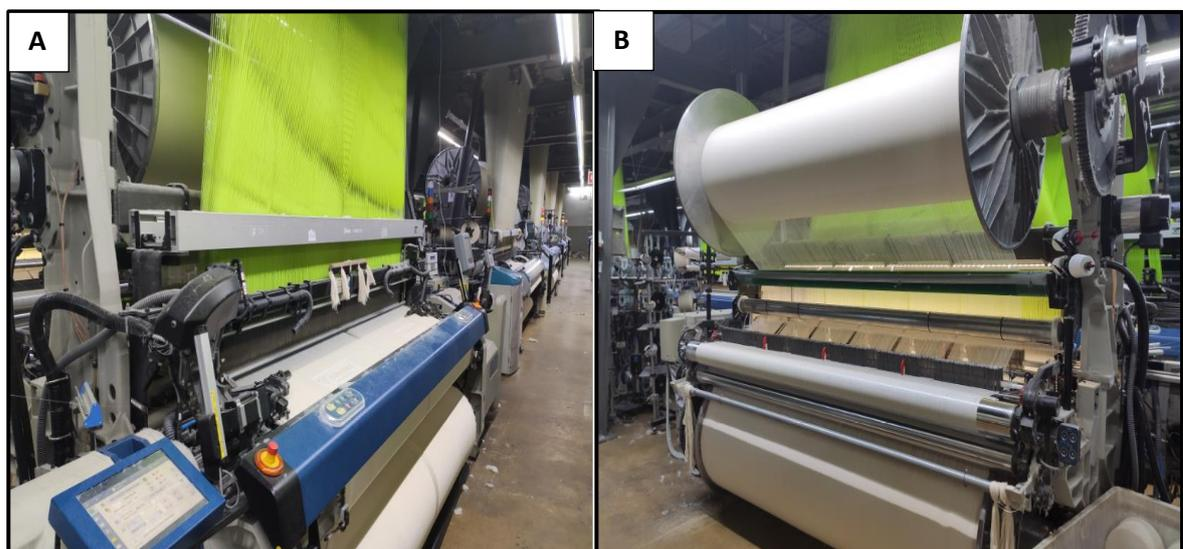
Figura 12 - Vista frontal de um tear - A; Vista traseira de um tear -B
