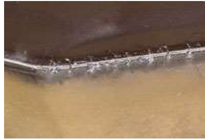
Figura 21 - Fissura por fadiga térmica (Sandvik Coromant, 2012)
