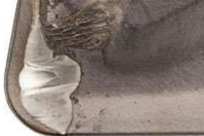
Figura 17 - Desgaste em cratera (Sandvik Coromant, 2012)
