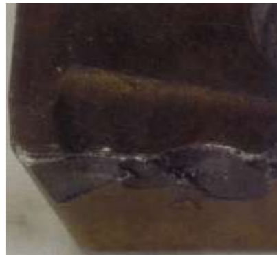
Figura 25 - Fratura em ferramenta (Silva, 2008b)
