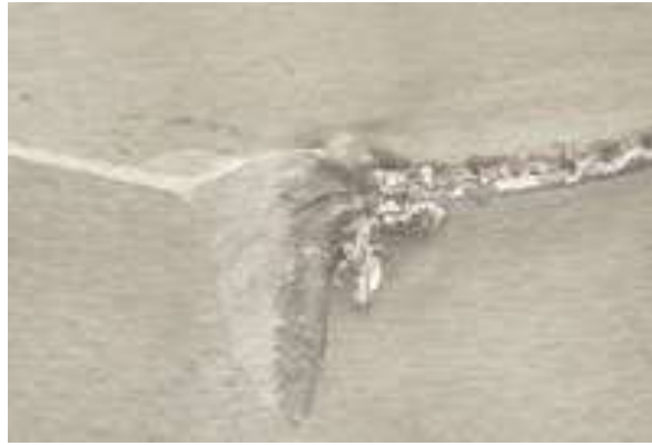
Figura 19 - Desgaste por entalhe (Sandvik Coromant, 2012)
