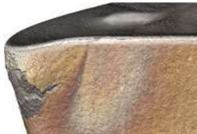
Figura 20 - Deformação plástica numa ferramenta (Sandvik Coromant, 2012)
