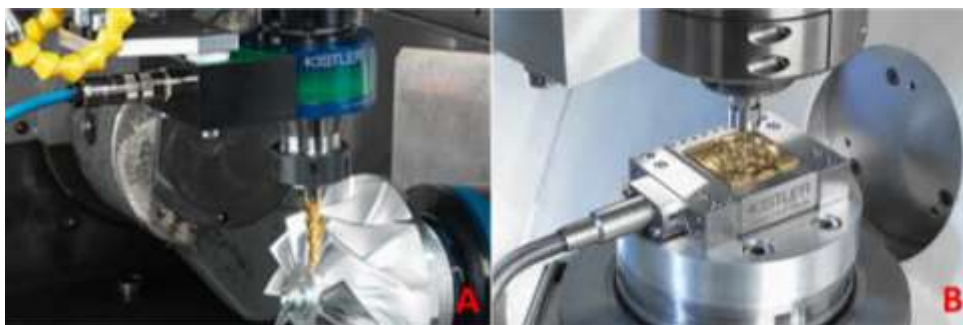
Figura 30 - A: Dinamómetro rotacional; B: Dinamómetro estacionário
