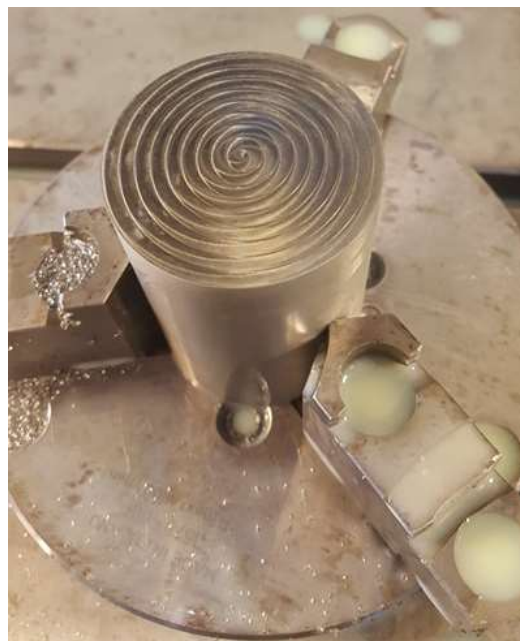
Figura 38 - Fixação da peça na bucha autocentrante
