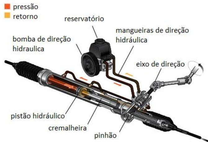
Figura 24 – Exemplo de um sistema de direção com utilização do mecanismo pinhão cremalheira (adaptado de [65])
