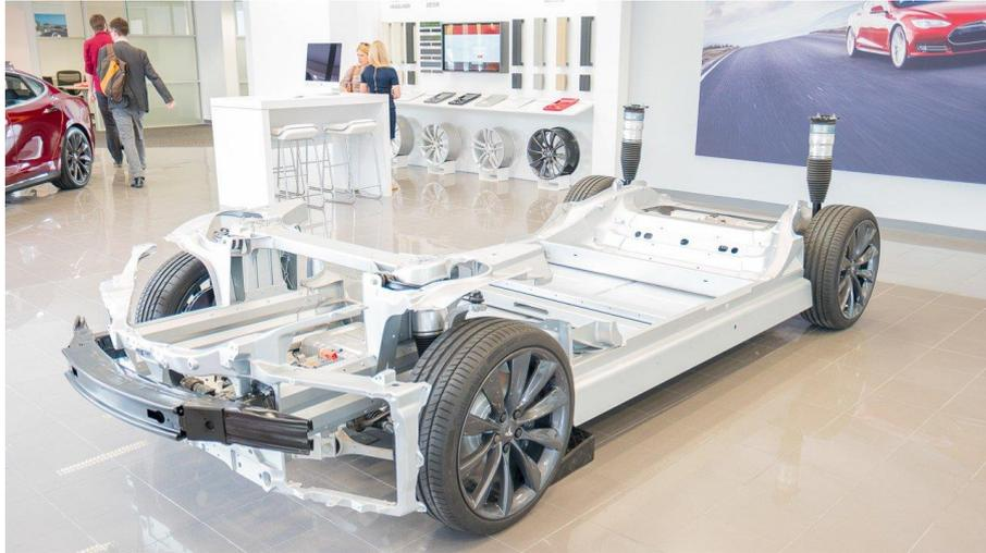
Figura 28 – Plataforma do Tesla Model S [67]
