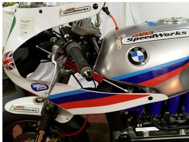
Figura 25 – Amortecedor de direção YSS [66]
