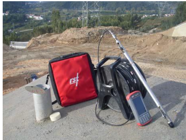
Figura 36. Equipamento de leitura de inclinômetro (retirado de Relatório de Instrumentação, 2017)
