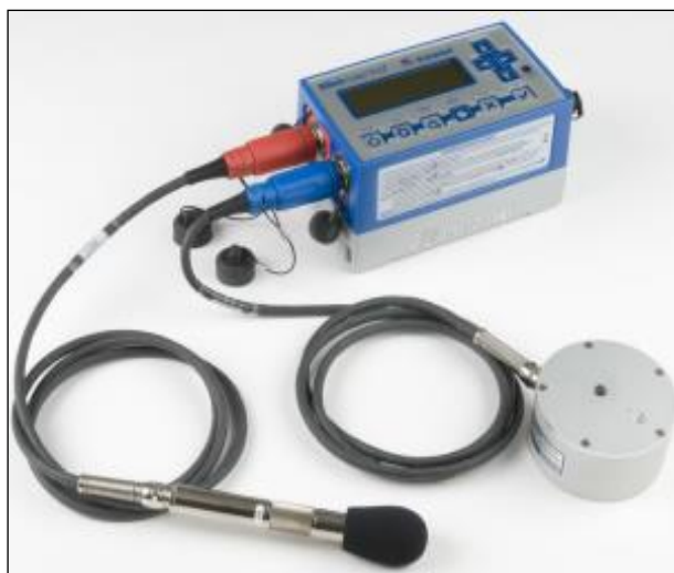
Figura 31. Equipamento de medição e registo de vibrações – sismógrafo (retirado de VMA, 2015)
