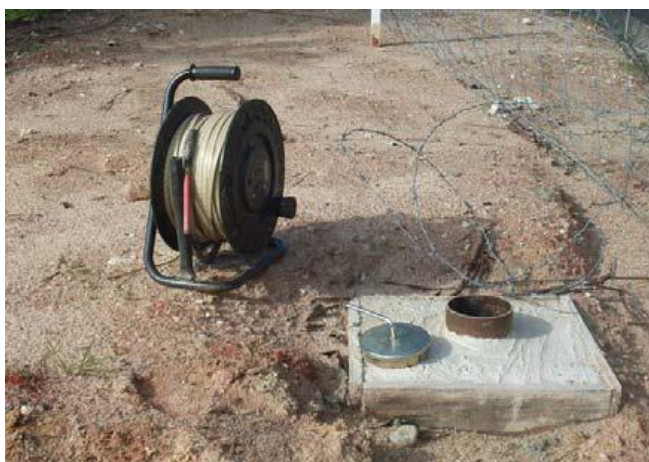
Figura 37. Sonda de leitura de piezómetros (retirado de Relatório de Instrumentação, 2017)
