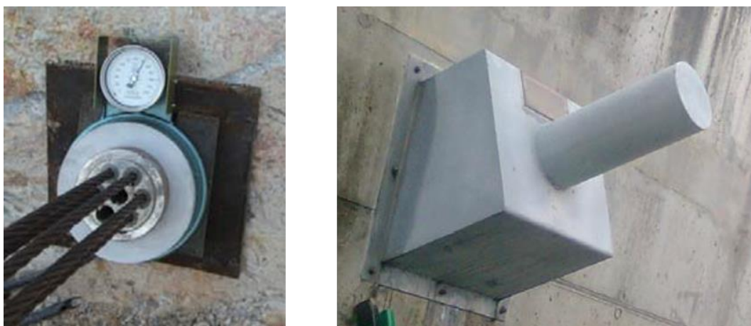
Figura 35. Células de Carga Manométricas (adaptado de Relatório de Instrumentação, 2017)
