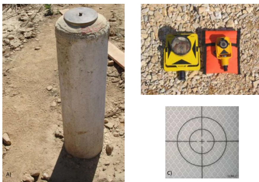
Figura 19. Pontos de observação: A) – Pilar solidarizado; B) – Prima e mini prisma; C) – Alvo refletor; (adaptado de Torres, 2010 e de Raposo, 2011)
