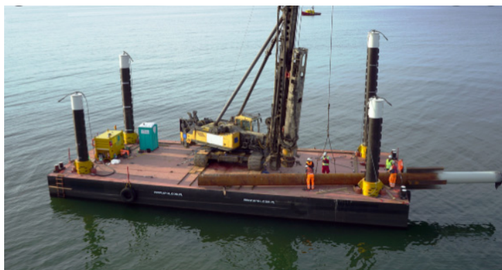
Figura 73 – Imagem de um pontão do tipo “jack-up” utilizado na reabilitação de estruturas costeiras (Fonte: https://www.workboatsales.com/vessel/24m-modular-jack-up-pontoon-for-sale-or-charter/ , consultado em outubro de 2019).
