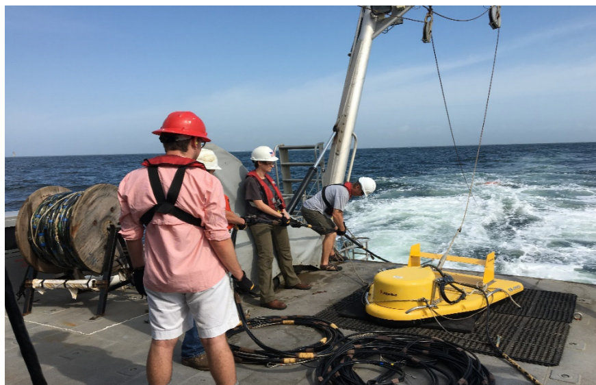
Figura 67 – Implementação do sistema de sonar CHIRP Edgetech 512i (Fonte: http://www-udc.ig.utexas.edu/external/facilities/subbottom/ , consultado em junho de 2020).
