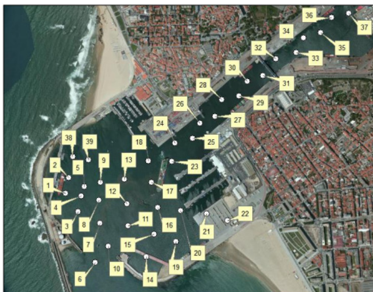
Figura 61 – Posicionamento das sondagens executadas no âmbito da campanha de prospeção no Anteporto e no canal de acesso à Doca nº 4 do Porto de Leixões (adaptado de Tecnasol, 2004; in Pacheco, 2014).
