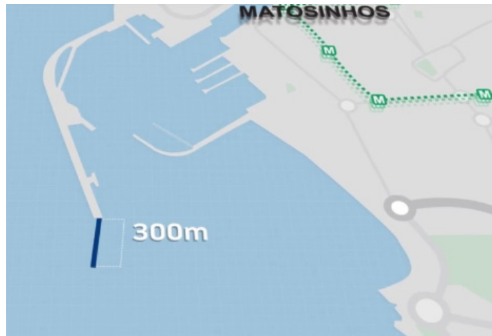
Figura 52 – Localização e extensão prevista, em metros, que irá ser implementada na extremidade do atual quebra-mar exterior de Leixões (APDL, 2019).
