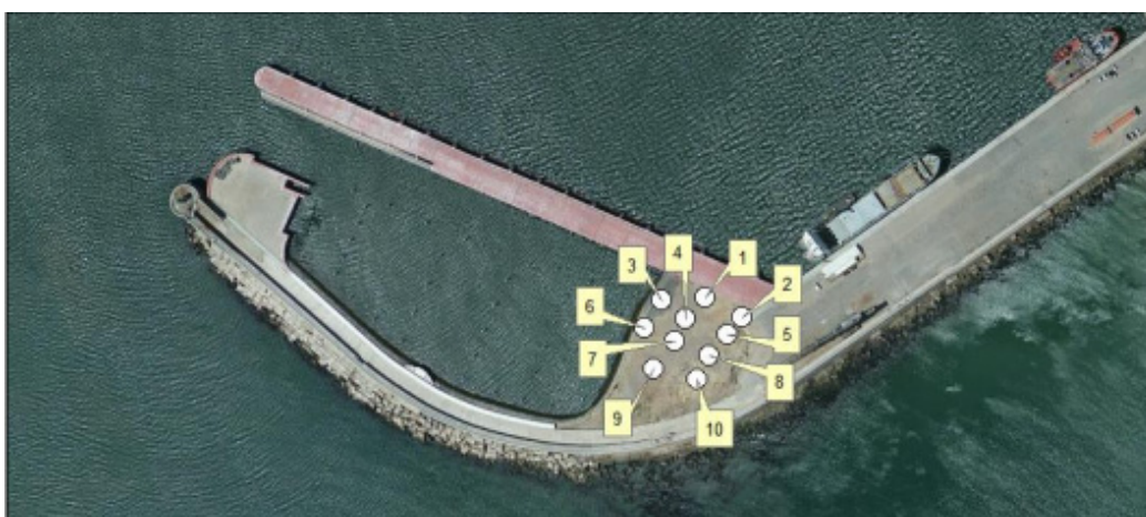
Figura 62 – Posicionamento dos furos das sondagens executados na campanha realizada em 2009 no âmbito do projeto de construção do Terminal de Passageiros do Porto de Leixões (Molhe Sul) (Pacheco, 2014).
