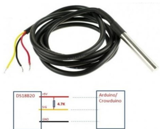
Figura 18 - Retificação da montagem do sensor de temperatura DS18B20 [41].
