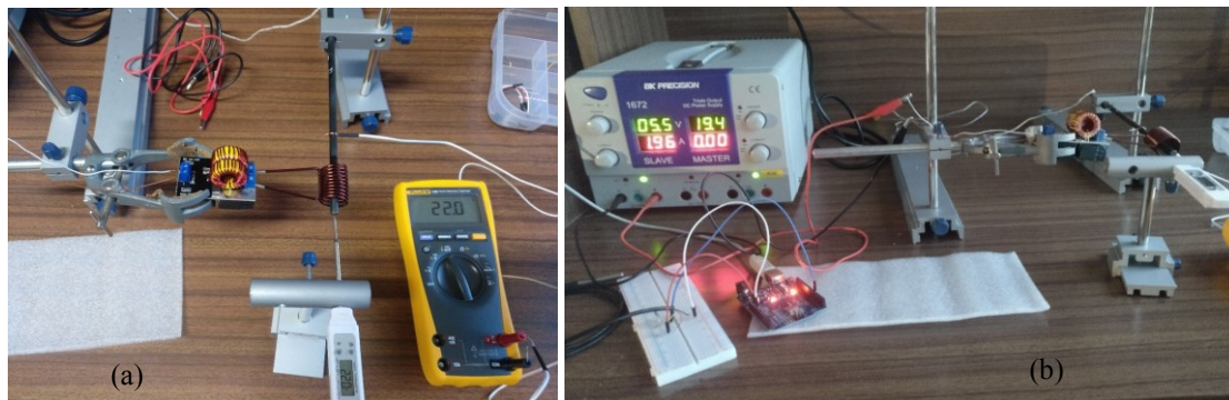
Figura 21 - Montagem do Circuito (a), Circuito com 5,5V aplicado ao módulo ZVS (b)
