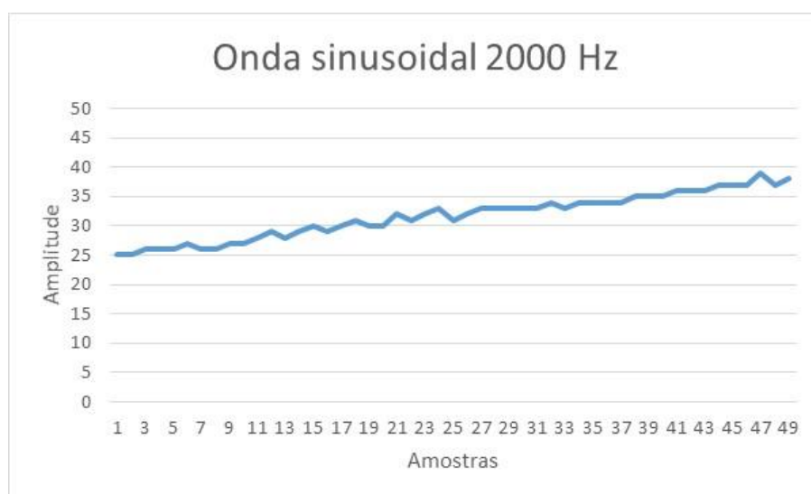
Figura 78 Reconstrução dos 50 primeiros pontos de uma onda sinusoidal de 2000 Hz.
