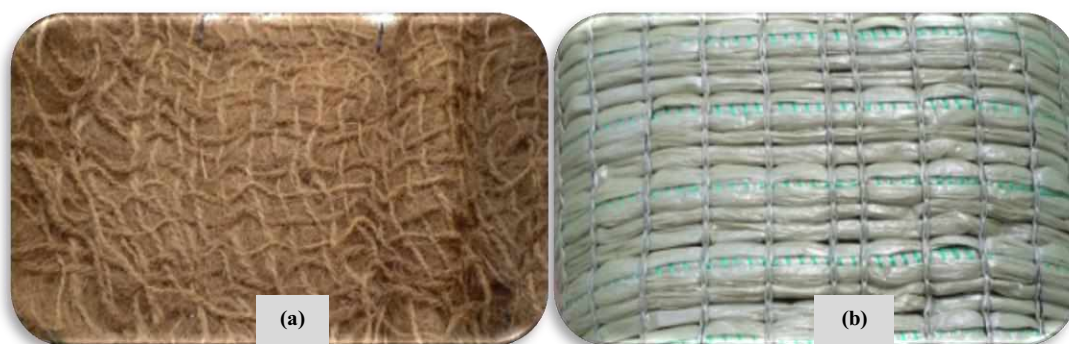
Figura 17- (a) Sistema de suporte (vista de cima) e (b) Sistema de flutuação (vista de baixo) da jangada flutuante utilizada.
