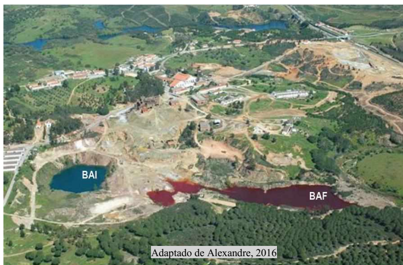
Figura 1-Vista aérea da zona mineira de Aljustrel, com a respetiva Barragem de Água Forte (BAF) e Barragem de Água Industrial (BAI).
