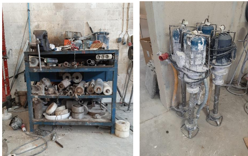
Figura 12 - [A] Rolos de limpa fretes reparados; [B] Bombas de vidragem reparadas
