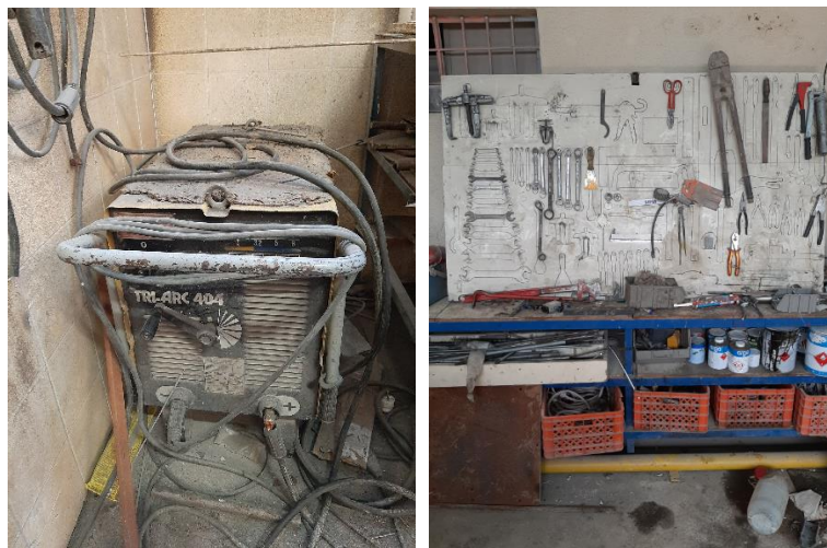
Figura 19 - [A] Máquina de soldar; [B] Quadro sombra (ambos com sujidade acumulada)
