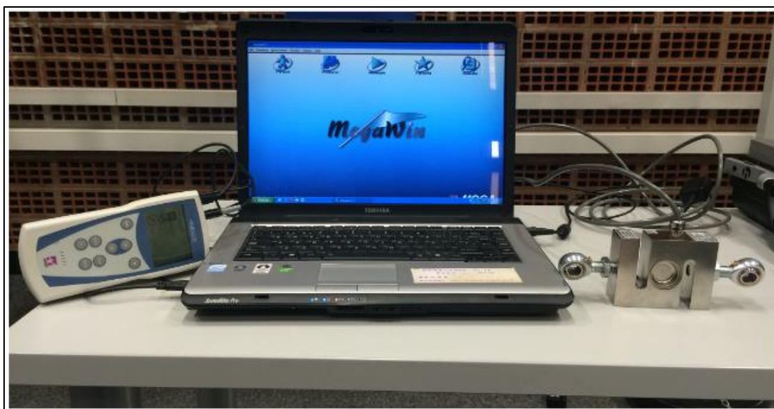
Figura 24. Elementos del acondicionador de señales - De izquierda a derecha: acondicionador de señales ME6000P8, software MegaWin™ y célula de carga resistiva tipo “S” modelo Lahti TB5
