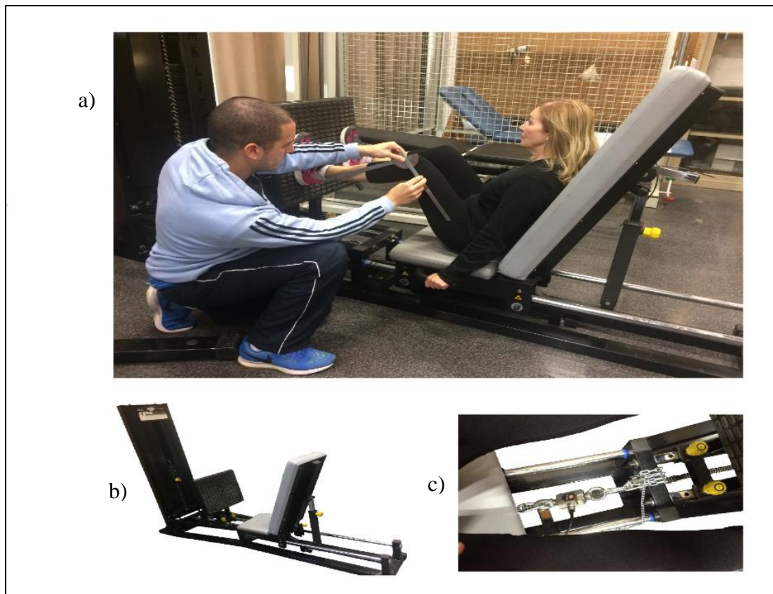
Figura 28. Test PSA - a. ejecución y realización de la prueba test de la prensa de piernas; b. máquina prensa de piernas; c. célula de carga anclada al apoyo podal
