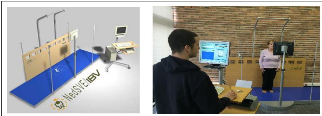
Figura 18. Plataforma dinamométrica (Dinascan/IBV P600)
