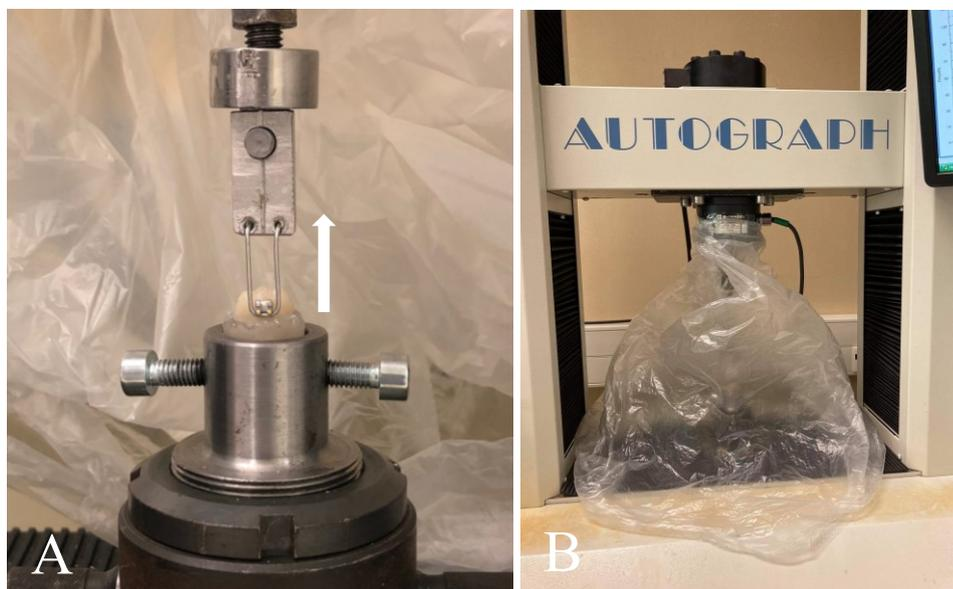
Figure 16: Cilindros montados na Máquina de Testes Universal. A – Vista vestibular; B – Aspetto final com o saco de plástico.
