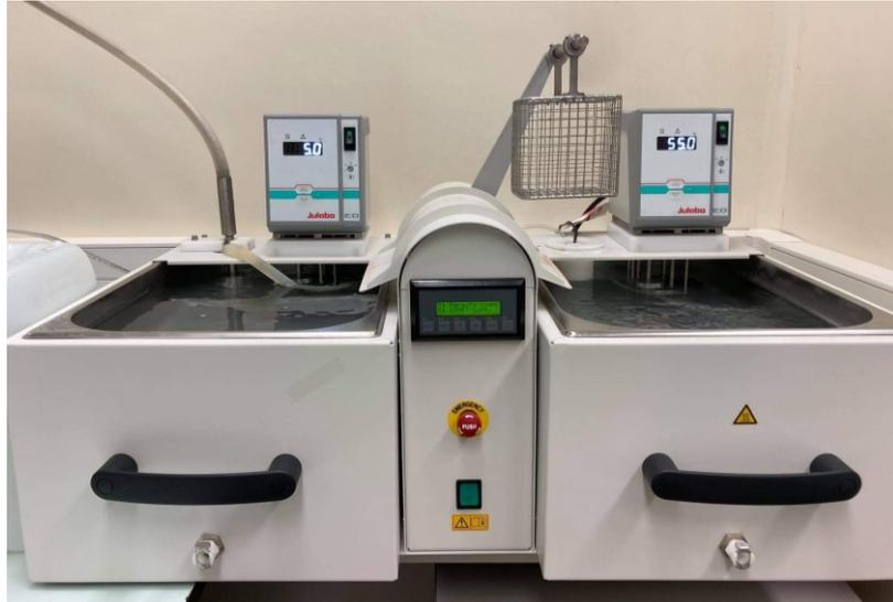
Figure 9: Termocicladora Julabo Labortech®.
