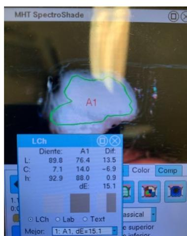
Figura 9 – Exemplo de medição dos valores de L\*a\*b\*.
