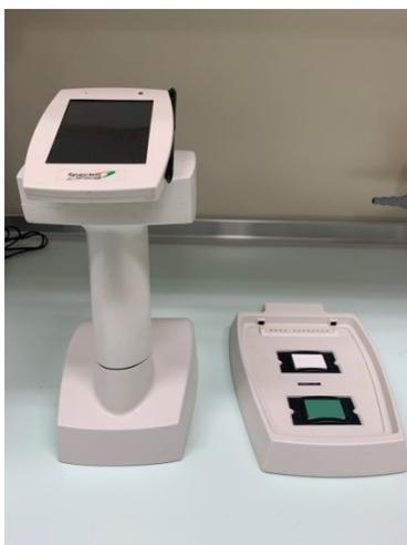
**Figura 1 – Espectrofotómetro SpectroShade Micro Optic (à esquerda) e a base de calibração do aparelho (à direita).**
