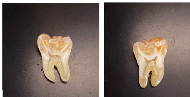
Figura 3 - Amostra do dente após ser seccionado em duas metades e preenchimento da câmara pulpar com cola de cianoacrilato.
