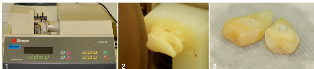
Figura 7 – 1- Micrótomoto de tecidos duros (Accuntom-50, Struers A/S, Ballerup, Denmark); 2- Dente fixo ao suporte acrílico e alinhado para corte; 3- Dente seccionado em metades idênticas
