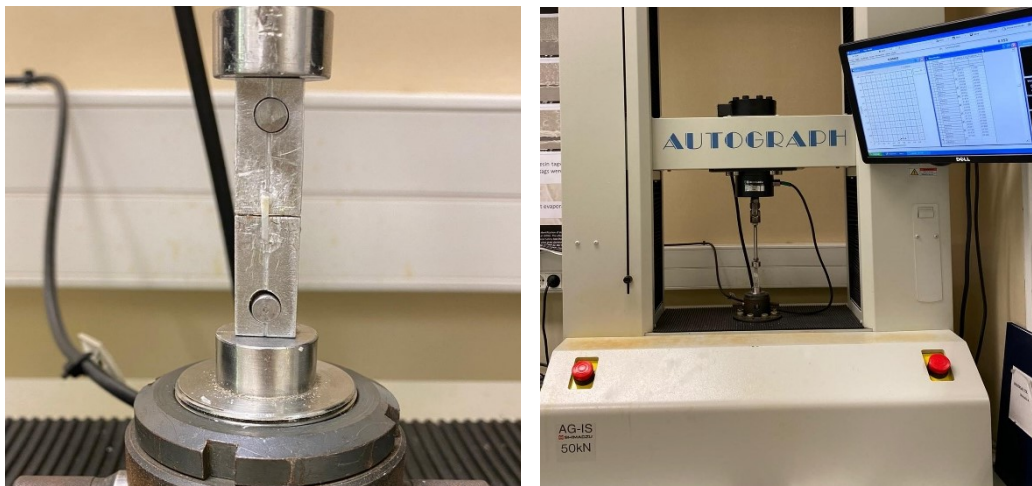
Figura 14. Teste de microtração na máquina de testes universais (A: Palito no jig de Geraldeli; B: Máquina de testes universais Shimadzu Autograph AG-IS)
