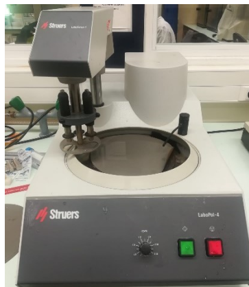
Figura 10. Representação da máquina polidora LabPol-4 com uma lixa Sic de 600 grit
