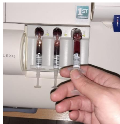
Fig. 9 – Colocação da seringa no dispositivo para análise
