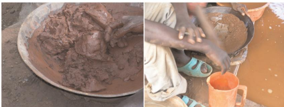
Figura 1.4 – Trabalhadores na Tanzânia misturando manualmente mercúrio com sedimentos dragados do leito do rio ou de terra escavada, para provocar a amálgama com pequenas partículas de ouro que posteriormente é separada da lama (12).
