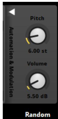
Figura 5.5: Exemplo de utilização de um modelador aleatório no parâmetros volume e tom no programa FMOD
