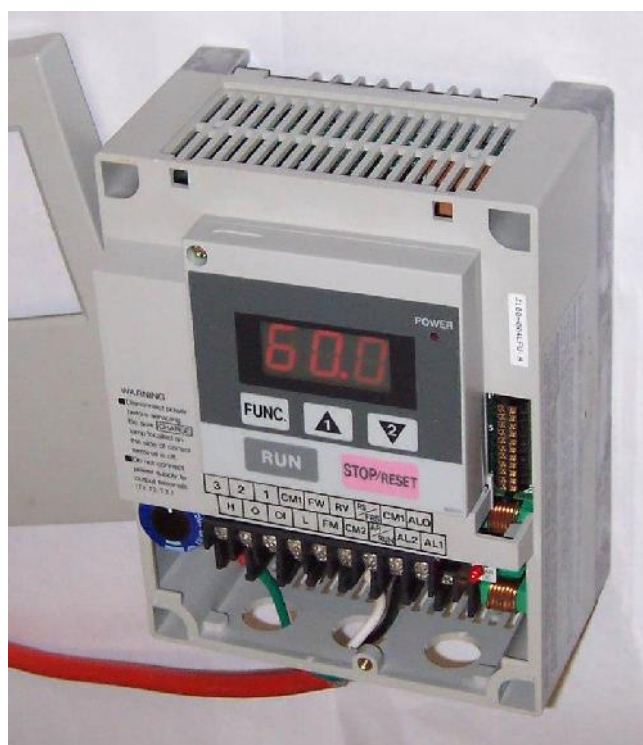
Figura 11. Variador de Frecuencia.
