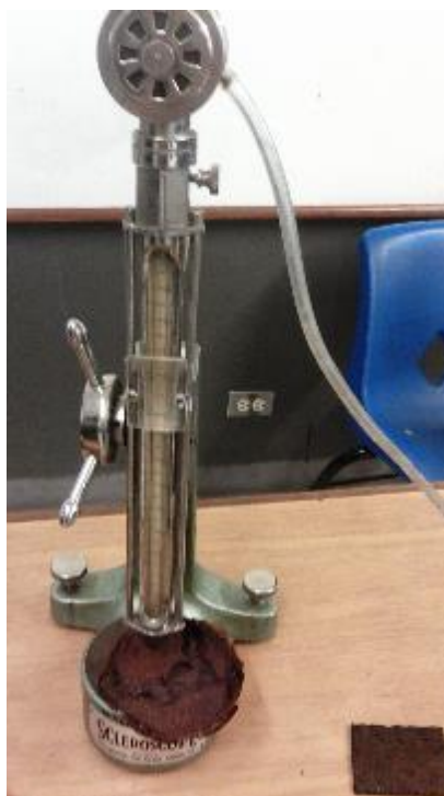
Figura 12. Escleroscopio en el cual se realizó la prueba de dureza Shore C al bioplástico [Elaboración propia]
