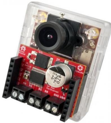
Figura 3.8 Tarjeta OpenMV conectada con shield para motores
