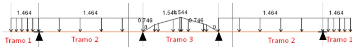
Figura 6.1.1. Cargas distribuidas en la viga V-3 por peso de las losas.
