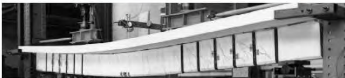
Después del ensayo a la falla
