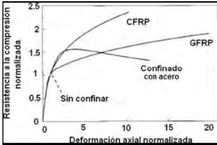
Figura 13: Diagrama Resistencia vs deformación axial de la columna (Fuente: Rosero, 2013)
