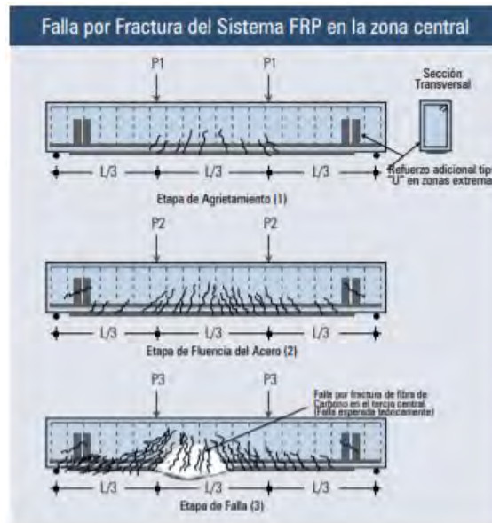
Figura 8: Falla por fractura del FRP en zona central (Fuente: Baca, 2016)
