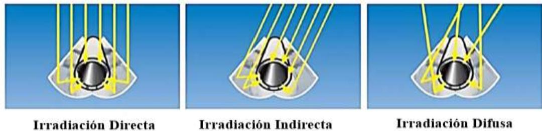
**Figura 17.** Aprovechamiento de la radiación en diferentes tipos de CPC [40].
