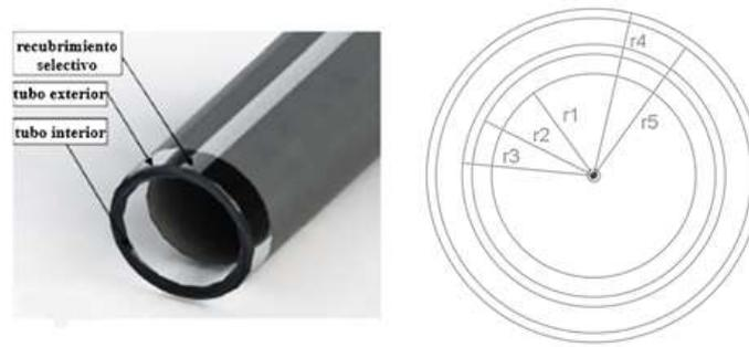
Figura 39 Parámetros del tubo de vacío. Elaborado por Carvajal & Mejía.
