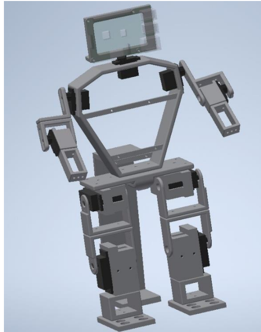
Figura 19. Estructura interna del asistente robótico (Versión 1.0) Fuente: Autor
