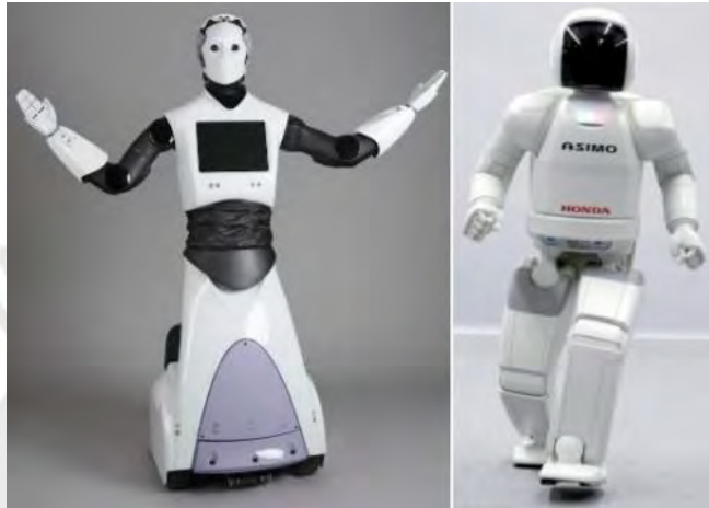
Figura 3. Robot humanoide con ruedas y robot humanoide bípedo. Fuente: Chavez, Cabrera (2013)
