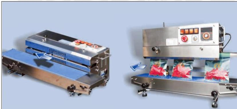
Ilustración 20 Selladoras de banda (horizontal y vertical)
