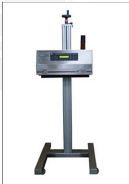
Ilustración 15 Selladora continua de inducción para tapas SIGMA I ACE
