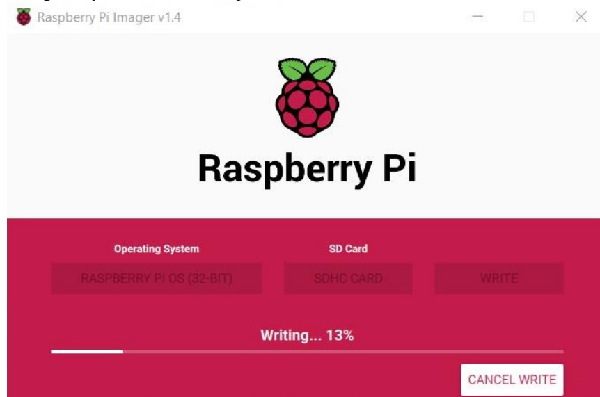
Figura 17. Instalación de Raspberry Pi OS en la tarjeta Micro SD. Elaborado por Ronald Cruz.
