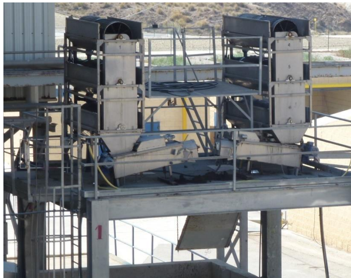
Imagen 5.2. Separador de fases de filtro de malla.
