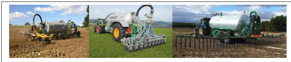
Imagen 1.1. Sistemas de aplicación de purín con inyección, discos y manguera.
