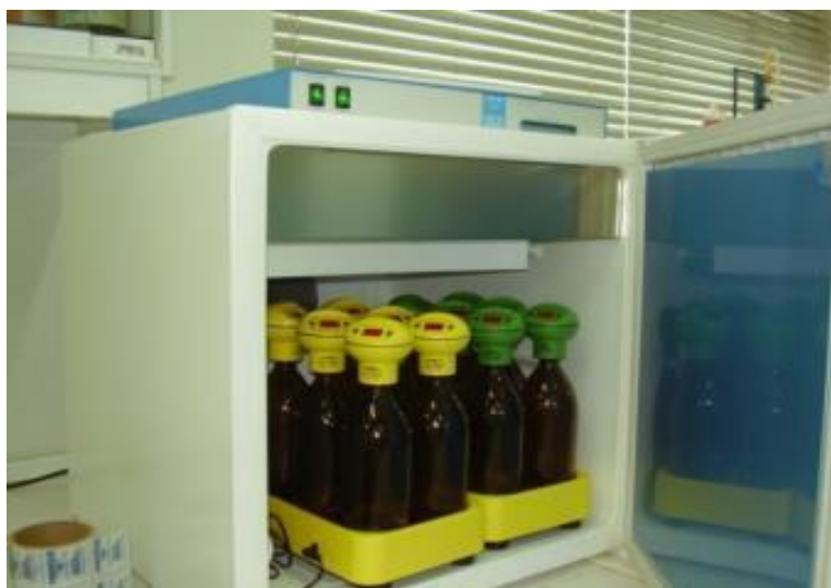
Foto 8.9. Biómetros e incubador para medida de DBO 5 .
