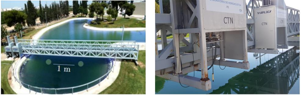
**Figura 4.11:** Montaje experimental en el Centro Tecnológico Naval y del Mar CTN. Balsa y ubicación de los transductores (izquierda) y sistema de posicionamiento (derecha)
