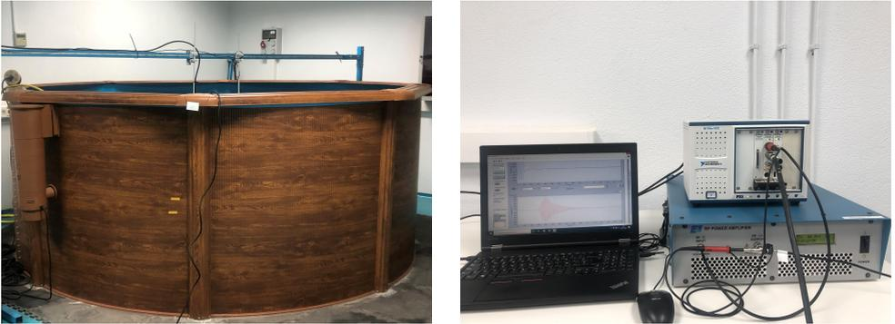
**Figura 4.8:** Montaje para la medida de TVR con una distancia entre transductores de 0.44 m en la piscina (izquierda). Equipos y conexionado empleados (derecha)
