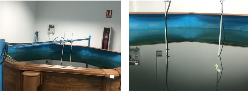
**Figura 4.10:** Montaje experimental para medidas en régimen no lineal. A la izquierda de la piscina, el hidrófono Reson TC4040 y a la derecha el transductor Airmar P19
