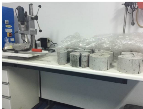
Figura 6.4 Probetas para determinación de la resistencia a cloruros
