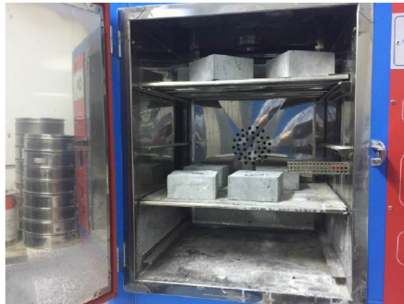
Figura 6.1. Ensayos de porosidad de los hormigones
