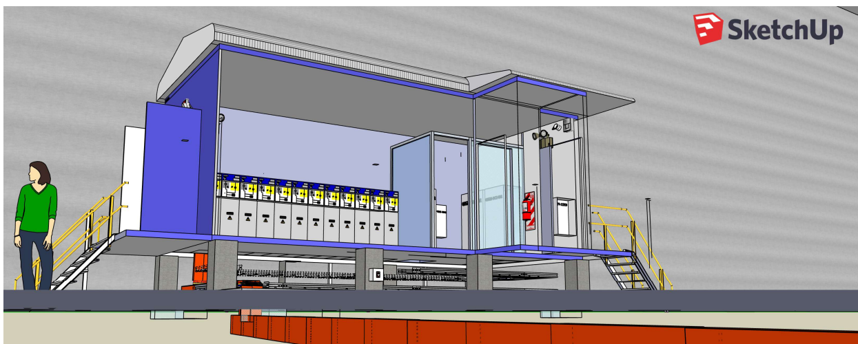
Ilustración 121.- Enlace CT-Cargadores-Baterías-Inversores-PV. 02. Sketchup
