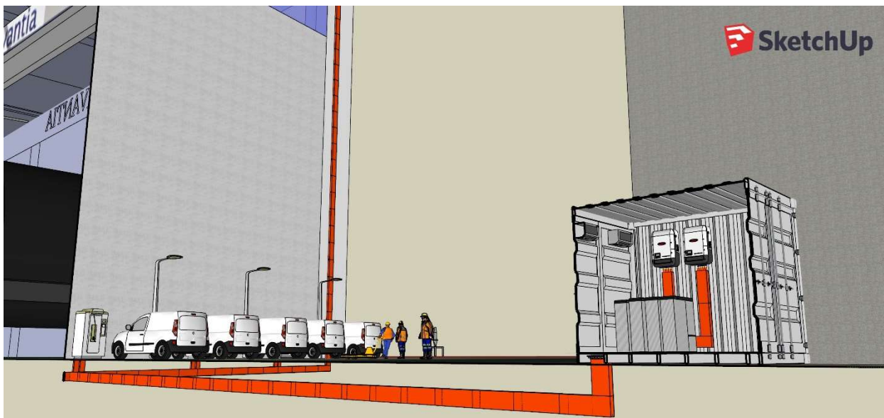
Ilustración 120.- Enlace CT-Cargadores-Baterías-Inversores-PV. 01. Sketchup
