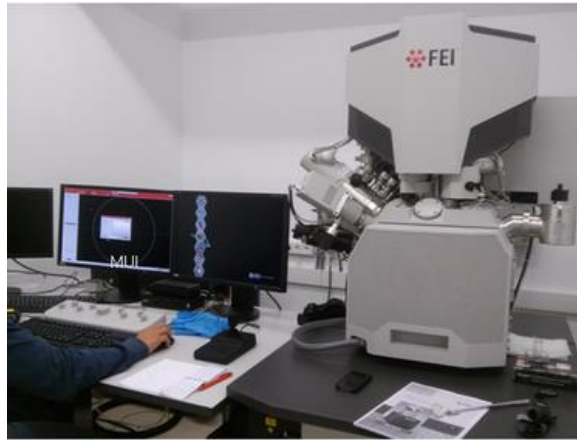
Figura 3.7 Microscopio SEM-FIB, Scios dualbeam (Universidad de Murcia).
