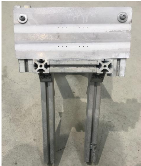
Figura 3.4 Bastidor con la placa que actúa como máscara.
