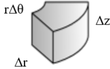
Figura 4.4. Elemento de volumen utilizado en los cálculos de solidificación (González Morales et al., 2020).
