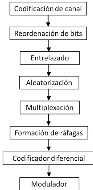
Figura 3.69. Procesamiento de la señal TETRA
