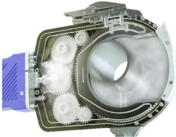
**Figura 2.38** – Disposición de engranajes
