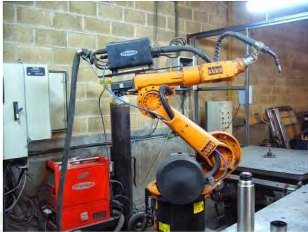
**Figura 2.4** – Robot KUKA con antorcha soldadora
