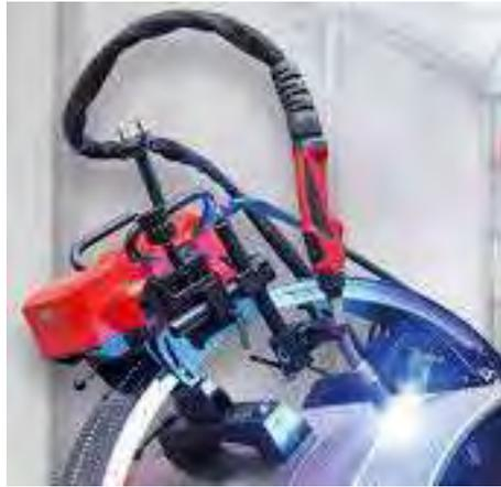
**Figura 2.5** – Vehículo Orbital para Soldadura de Tubería
