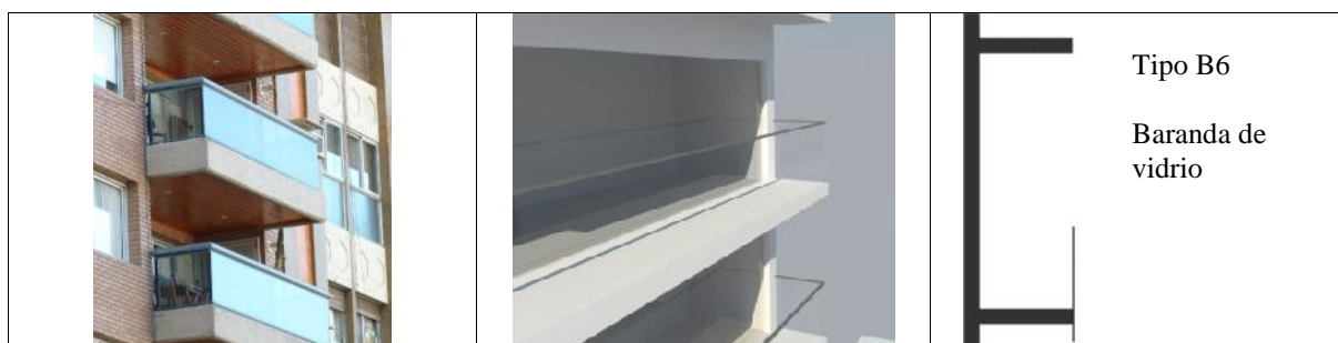
Figura 6: Balcón tipo B6 – baranda de vidrio
