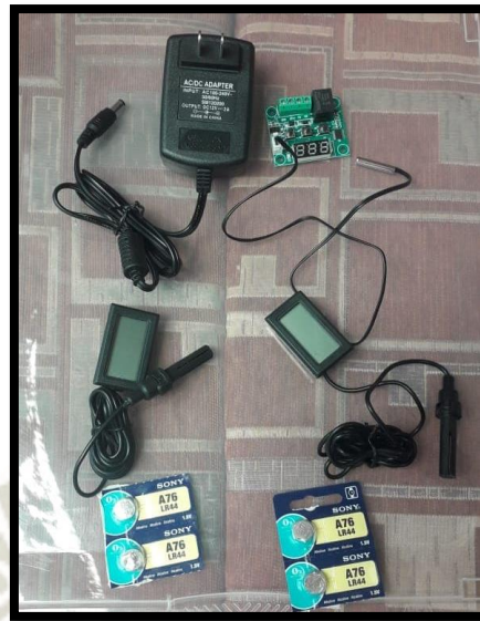
Fotografía N° 04: Termostato y termohigrómetros.
