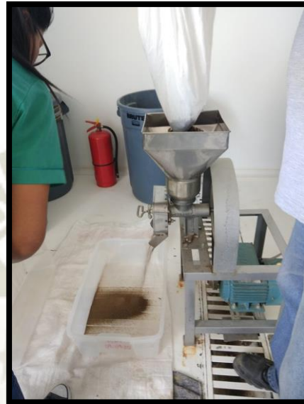
Fotografía 07: Molienda de larvas desecadas de Tenebrio molitor .
