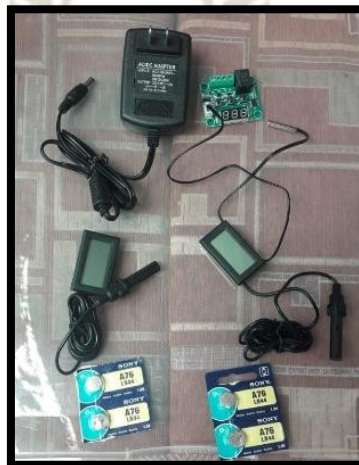
Fotografía N° 03: Termostato y termo higrómetros para control de temperatura y humedad.
