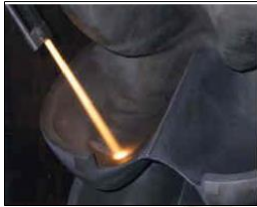
Figura 28: Recubrimiento sobre una turbina Pelton Fuente: ARSIDE, Proyección térmica y recargues.
