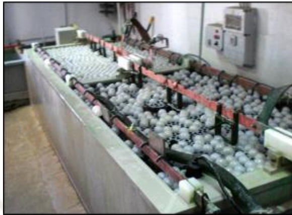
Figura 13: Cuba de Electrolisis para el cromado
