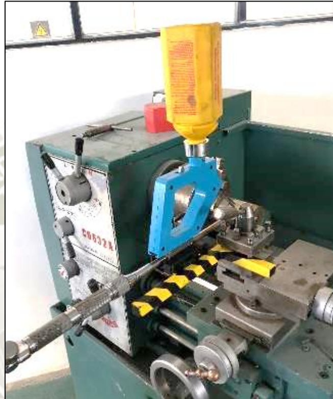
Figura 74: Prueba de Soporte Fijo de Negro y amarillo en Torno de la UCSM Fuente: Propia
