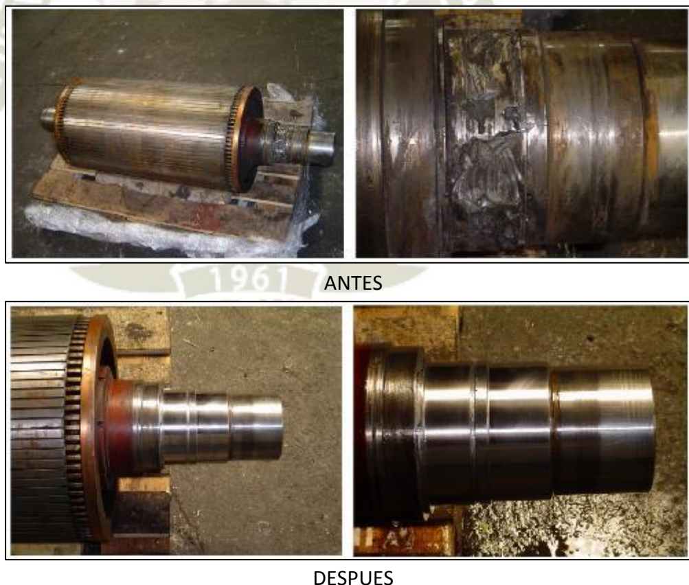
Figura 32: Gripaje de rodamiento de un rotor eléctrico antes y después de ser metalizado. Fuente: ARSIDE, Proyección térmica y recargues.
