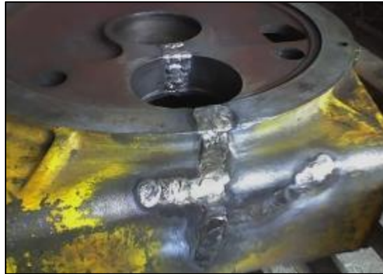
Figura 18: Pieza recuperada por Soldadura Fuente: Industrias y Soluciones Metalmecánicas Colombia SAS
