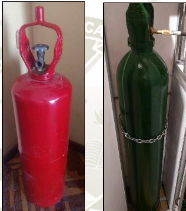
Figura 53: A la izquierda una botella de acetileno de 4kg y a la derecha una botella de oxígeno 8m 3 Fuente: Propia
