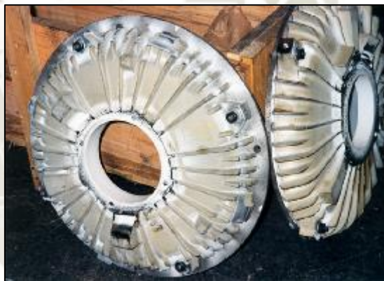
Figura 31: Material cerámico que aísla eléctricamente el sustrato Fuente: ARSIDE, Proyección térmica y recargues.
