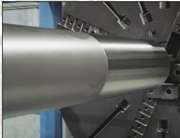
Figura 36: Recubrimiento de rodillos laminadores Fuente: Sector Industria Siderurgia – tecnocaucho.com
