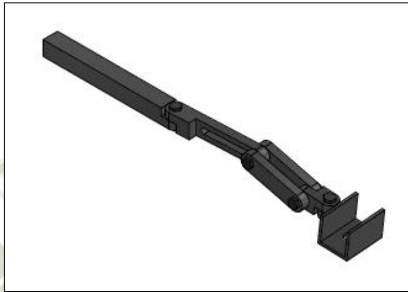
Figura 75: Diseño 3D Soporte móvil de pistola Rototec1A Fuente: Propia
