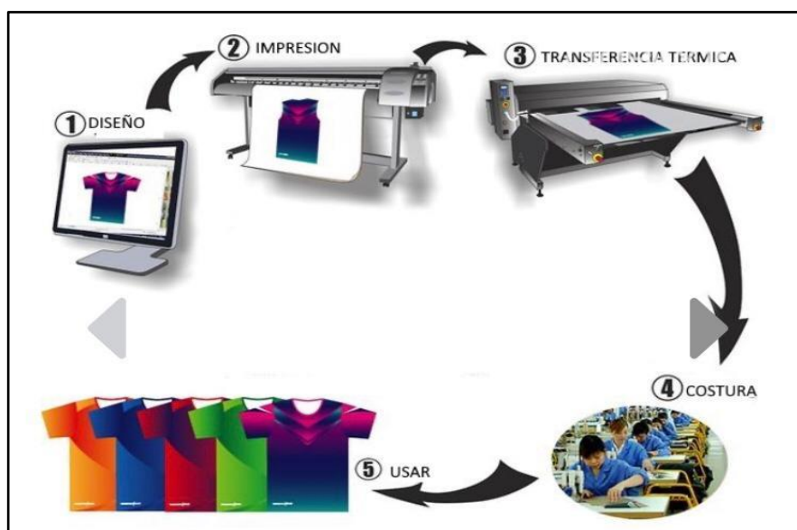
Ilustración 2. Proceso de sublimación y estampado transfer para textiles. Recuperado de: Clasipar.com 2019.
