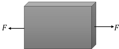
Si el material tiene un espesor menor a 2.5 cm; las deformaciones y los defectos se mantienen en el plano. Esto se llama deformación plana
