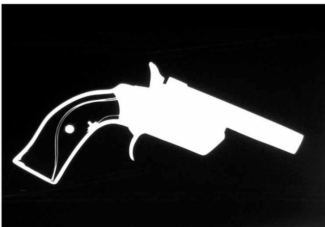
Figura 10. Radiografía de una evidencia que ingresa embalada en una caja de cartón, rotulada como arma de fuego hechiza. Para evitar los peligros en su manipulación, se toma una radiografía antes de la apertura de la caja con el fin de comprobar que el gatillo se encuentra en su posición inicial; con lo cual el peligro de dispararse accidentalmente durante la apertura es menor.
