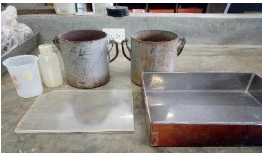
Figura 11. Materiales utilizados en la calibración del molde de pesos unitarios
