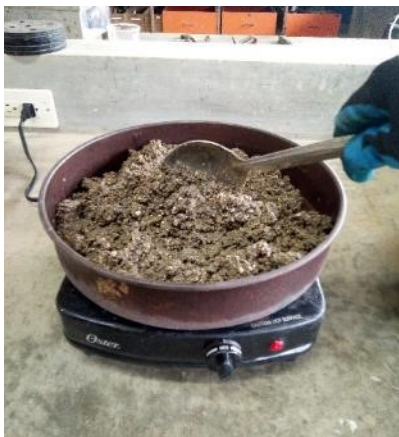
Figura 15. Secado de la muestra de agregado fino
