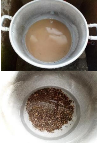
Figura 9. Material antes y después del lavado por el tamiz N°200
