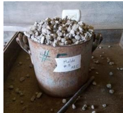
Figura 12. Última capa de varillado en el agregado grueso
