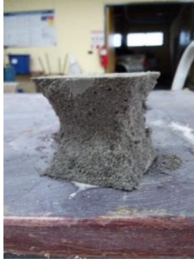
Figura 36. Especimen cúbico fallado
