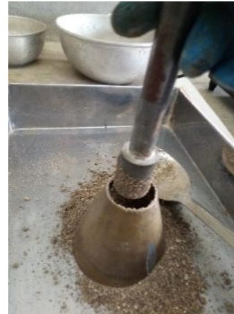
Figura 16. Apisonado de la muestra de agregado fino en el molde cónico
