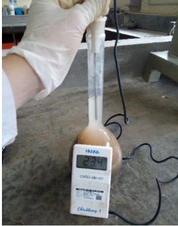
Figura 17. Verificación de la temperatura de la muestra sin burbujas
