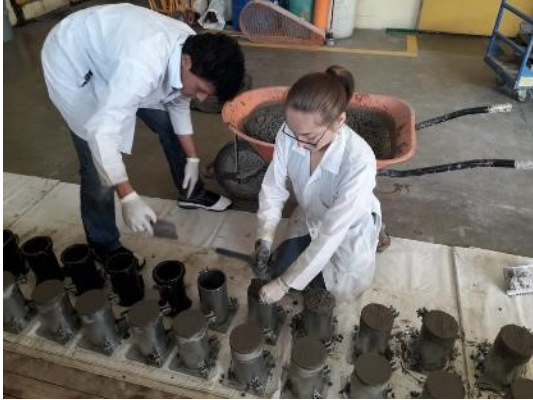
Figura 23. Varillado y llenado de los cilindros de concreto
