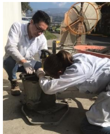
Figura 22. Medición del asentamiento del concreto
