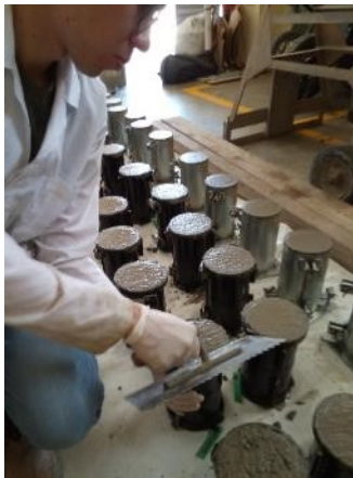
Figura 25. Terminación del cilindro con llaneta
