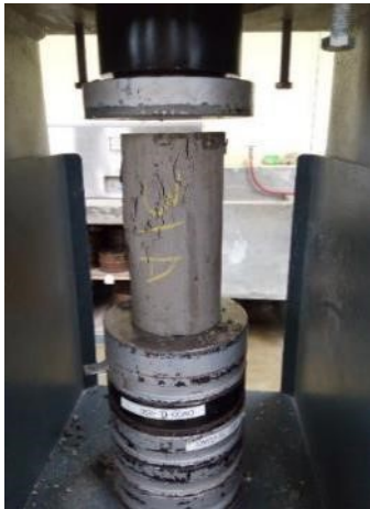
Figura 28. Cilindro después de la falla
