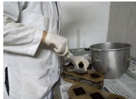
Figura 32. Llenado de la primera capa de mortero
