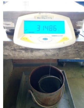
Figura 14. Determinación de la masa SSS sumergida
