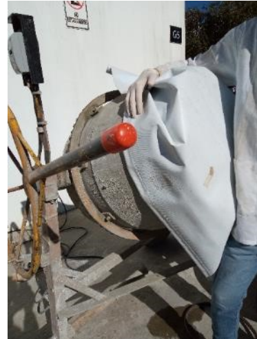
Figura 20. Mezcladora cubierta durante el tiempo de reposo
