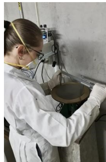
Figura 29. Medición del flujo del mortero
