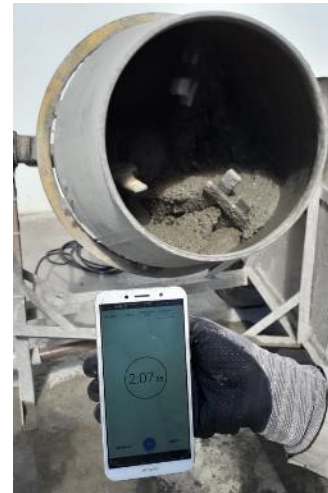
Figura 21. Control de los tiempos de mezclado con cronómetro
