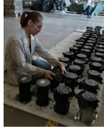
Figura 26. Cobertura de los moldes con plástico
