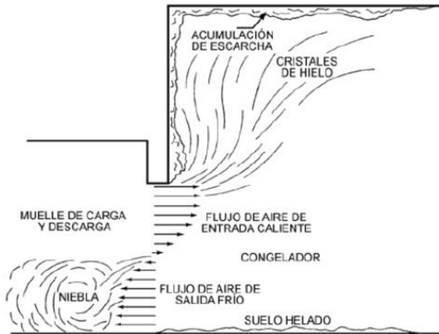
Figura # 17. Flujo de aire caliente y aire frío en las puertas abiertas de una cámara.
